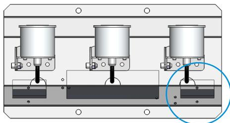
4. Fixer le boîtier de raccordement 230 VAC sur le support de fixation avec le collier de serrage.
